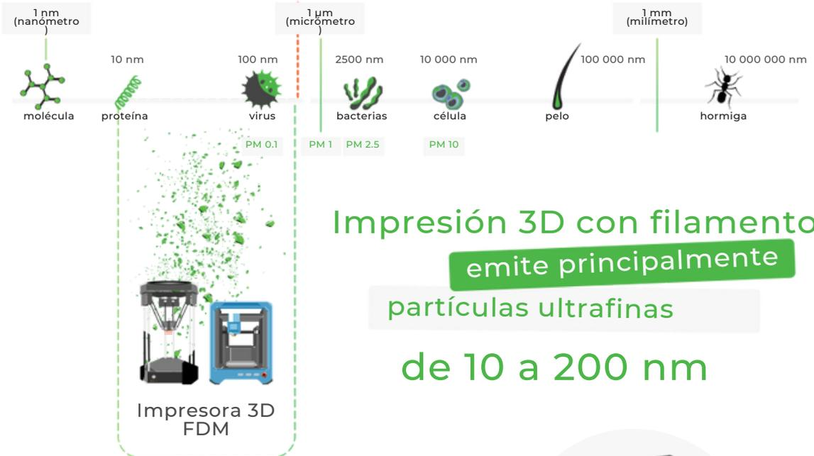
Impresión 3D con filamento emite principalmente partículas ultrafinas de 10 a 200 nm
